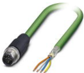
网络电缆, PROFINET CAT5 (100 Mbps), 4-芯, PUR, 绿色RAL 6018, 插头 直头 M12, 与 自由出线, 电缆长度: 2 m
