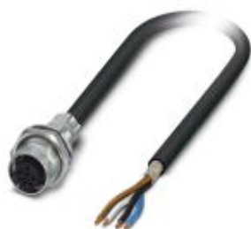
孔式插座，屏蔽，4芯，M12，A编码，板后/M16螺纹安装，带2 m电缆，4 x .34 mm 2
