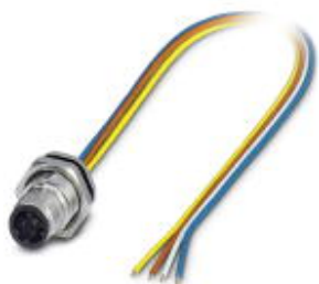
总线系统插座，PROFINET，4芯，M12-SPEEDCON，D编码，板后/M16螺纹安装，带0.5mTPE绞线，4 x 0.34 mm²
