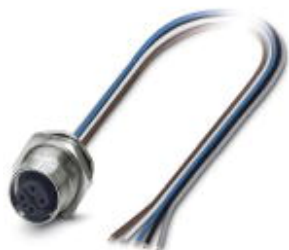
传感器/执行器孔式插座，5芯，M12 SPEEDCON，B编码，板后/M16螺纹安装，带0.5 m TPE绞线，5 x 0.34 mm 2
