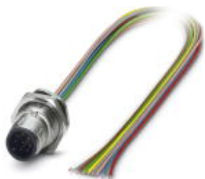
传感器/执行器针式插座，12芯，M12 SPEEDCON，板后/M16螺纹安装，带.5 m TPE绞线，12 x 0.14 mm²
