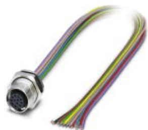
传感器/执行器孔式插座，12芯，M12 SPEEDCON，板后/M16螺纹安装，带0.5m无卤素TPE纹线，12 x 0.14 mm²
