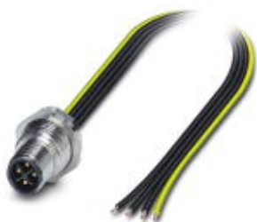
针式插座，电源，4-芯，插头，M12，S电源，板后安装，M16 x 1.5，单线，电缆长度: 0.5 m
