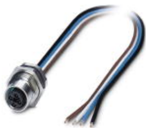
针式插座，电源，4-芯，孔式，M12，T电源，板后安装，M16 x 1.5，单线，电缆长度: 0.5 m
