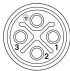
M12孔式引脚分配，4位，S编码，孔式连接器侧视图
