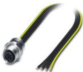
针式插座，电源，4-芯，孔式，M12，S电源，板前安装，M16 x 1.5，单线，电缆长度: 0.5 m
