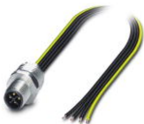
传感器/执行器针式插座，4芯，板前/M16螺纹安装，带0.5 m PP绞线，4 x 1.5 mm 2
