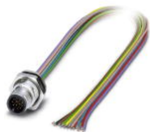
传感器/执行器插座，12芯，M12 SPEEDCON，板后/Pg9螺纹安装，带0.5m无卤素TPE绞线，12 x 0.14 mm²
