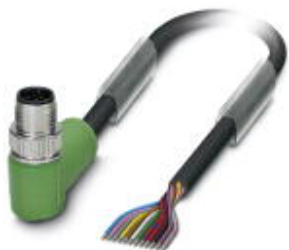
传感器/执行器电缆，12-芯，PUR 无卤素，黑色 RAL 9005，插头 弯头 M12 SPEEDCON，A编码，与 端自由出线，电缆长度: 5 m
