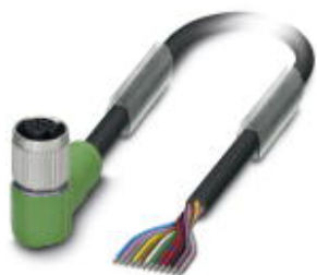
传感器/执行器电缆，12-芯，PUR 无卤素，黑色 RAL 9005，端自由出线，与 孔式 弯头 M12 SPEEDCON，A 编码，电缆长度: 5 m
