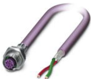
总线系统孔式插座，PROFIBUS，2芯，M12，屏蔽，B编码，SPEEDCON，板后/Pg9螺纹安装，带5.0m总线电缆，2x0.25mm 2
