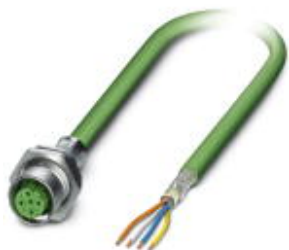
总线系统孔式插座，PROFINET，4芯，M12，屏蔽，D编码，SPEEDCON，板后/Pg9螺纹安装，带0.5m总线电缆，2x2x0.34mm 2
