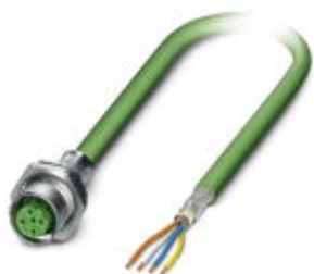
总线系统孔式插座，PROFINET，4芯，M12，屏蔽，D编码，SPEEDCON，板后/Pg9螺纹安装，带2.0m总线电缆，2x2x0.34mm 2
