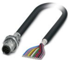
暗装连接器，屏蔽，12芯，M12，A型防插错编码，板后/M16螺纹安装，带2 m电缆，12 x 0.14 mm 2
