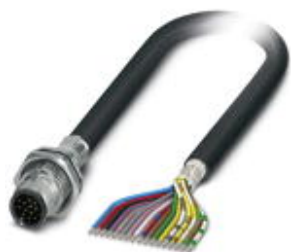
暗装连接器，屏蔽，17芯，M12，A型防插错编码，板后/M16螺纹安装，带2 m电缆，17 x 0.14 mm 2
