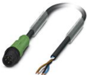
传感器/执行器电缆，4-芯，PUR 无卤素，黑-灰色 RAL 7021，插头 直头 M12，A编码，与 端自由出线，电缆长度: 1.5 m，带塑料螺圈
