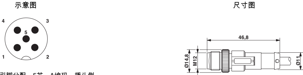
M12针式连接器引脚分配，5芯，A编码，插头侧
