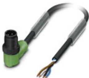
传感器/执行器电缆, 4-芯, PUR 无卤素, 黑-灰色 RAL 7021, 插头 弯头 M12, A编码, 与 端自由出线, 电缆长度: 1.5 m, 带塑料螺圈
