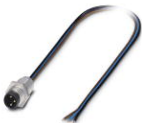
传感器/执行器面板安装式连接器，3位，M8，板前/M8螺纹螺钉安装，带0.5 m PVC绞合线，3 x 0.25 mm²
