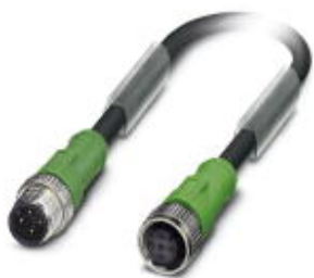
传感器/执行器电缆, 4-芯, PUR, 黑-灰色 RAL 7021, 插头 直头 M12, A编码, 与 孔式 直头 M12, A编码, 电缆长度: 2 m
