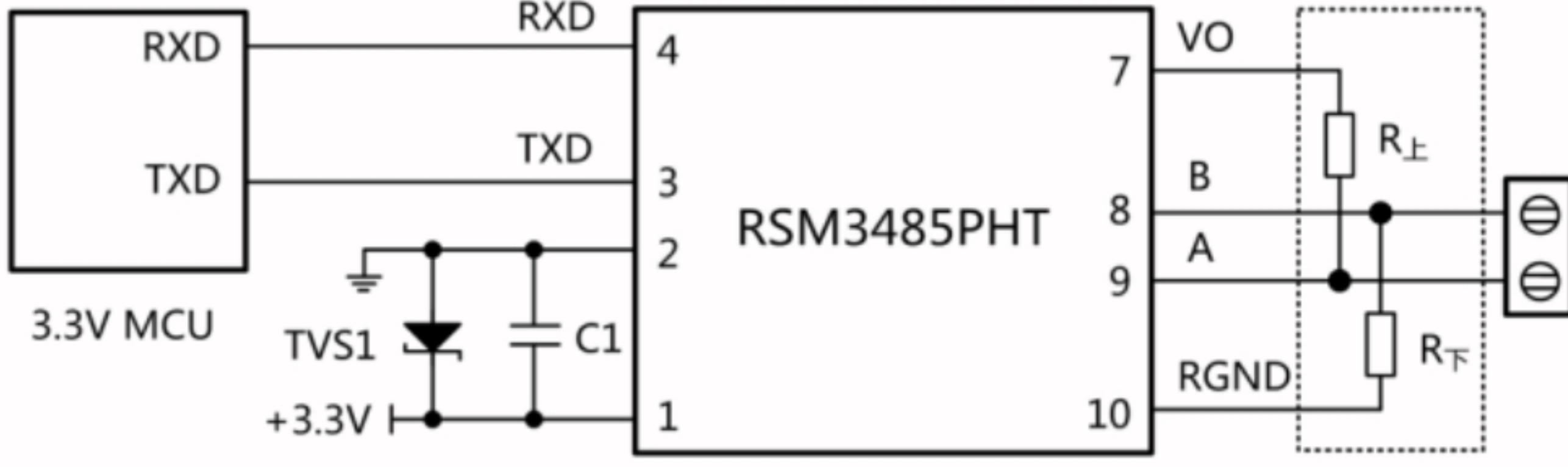
图2.MCU 3.3V供电应用电路
