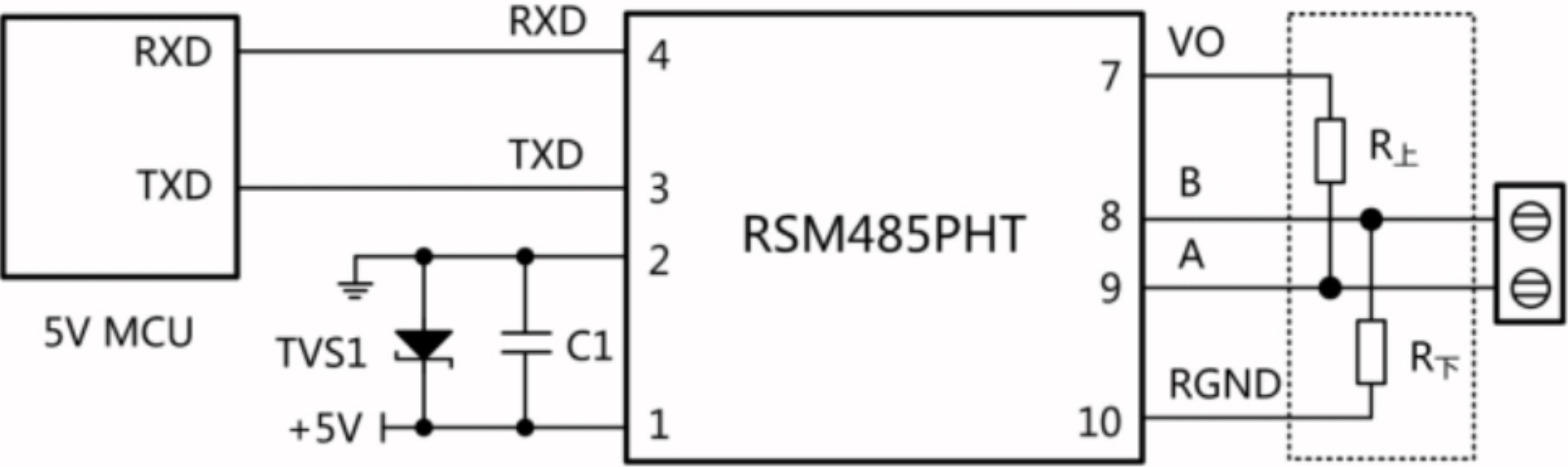
图1.MCU 5V供电应用电路
