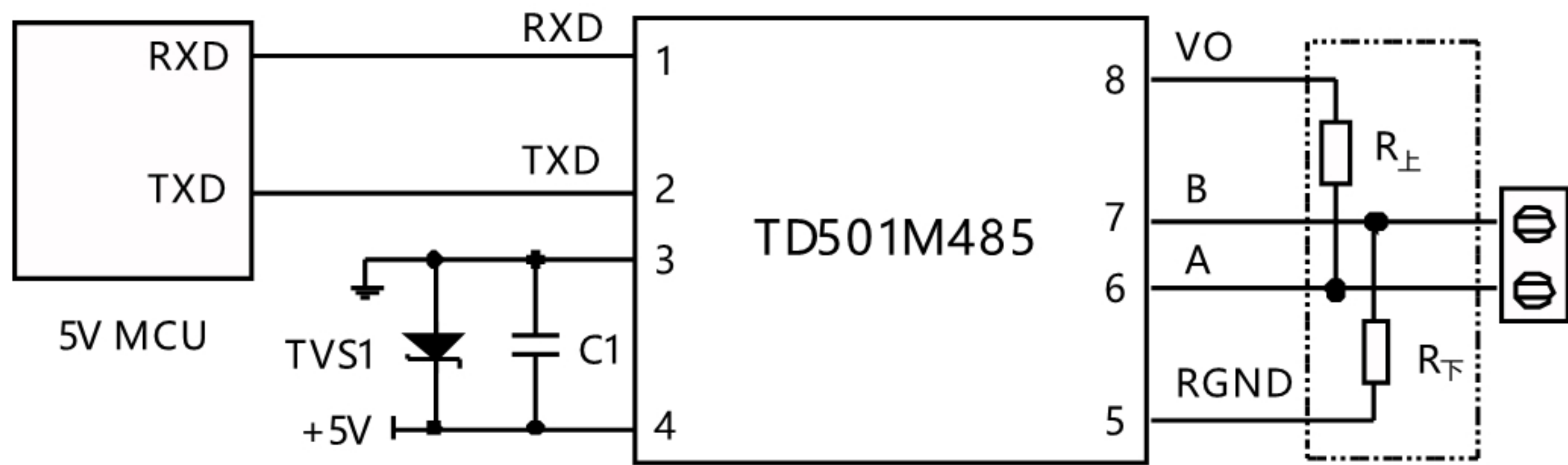
图 1.MCU 5V供电应用电路
