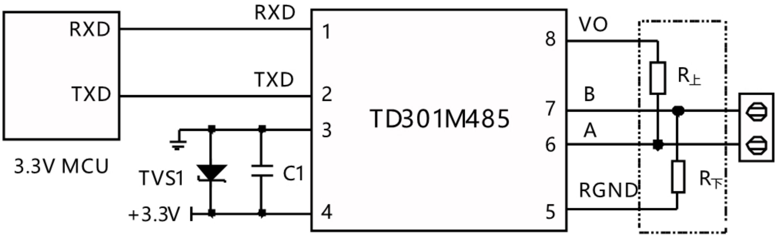
图 2.MCU 3.3V 供电应用电路
